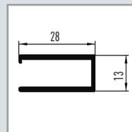
Das einteilige Seitenführungs-Profil 28 x 13 mm ist aus stranggepresstem Aluminium und führt in klassischer Weise die Behangkanten überdeckt.
